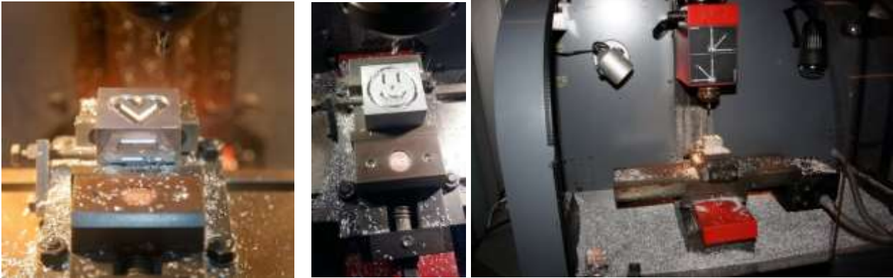
Detaļas izveide ar EMCO programmvadības frēzes darbagaldu (CNC) Tehnobusā
